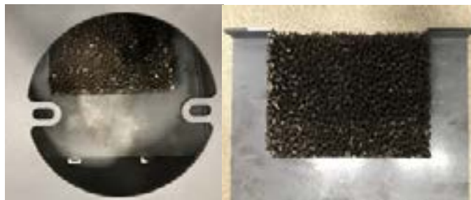
Katalysatormontage set fra røgstudsens over vermiculiterøgvenderpladen.
